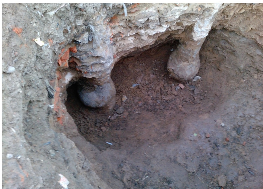
Рисунок 5. Форма уширений и прилегающая зона грунта.
