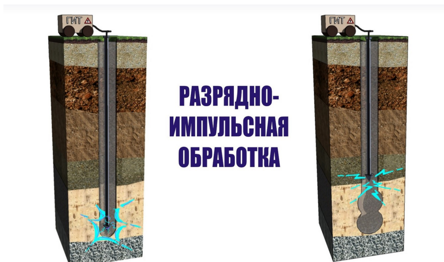
Рисунок 2. Разрядно-импульсная обработка пяты и ствола свай.
